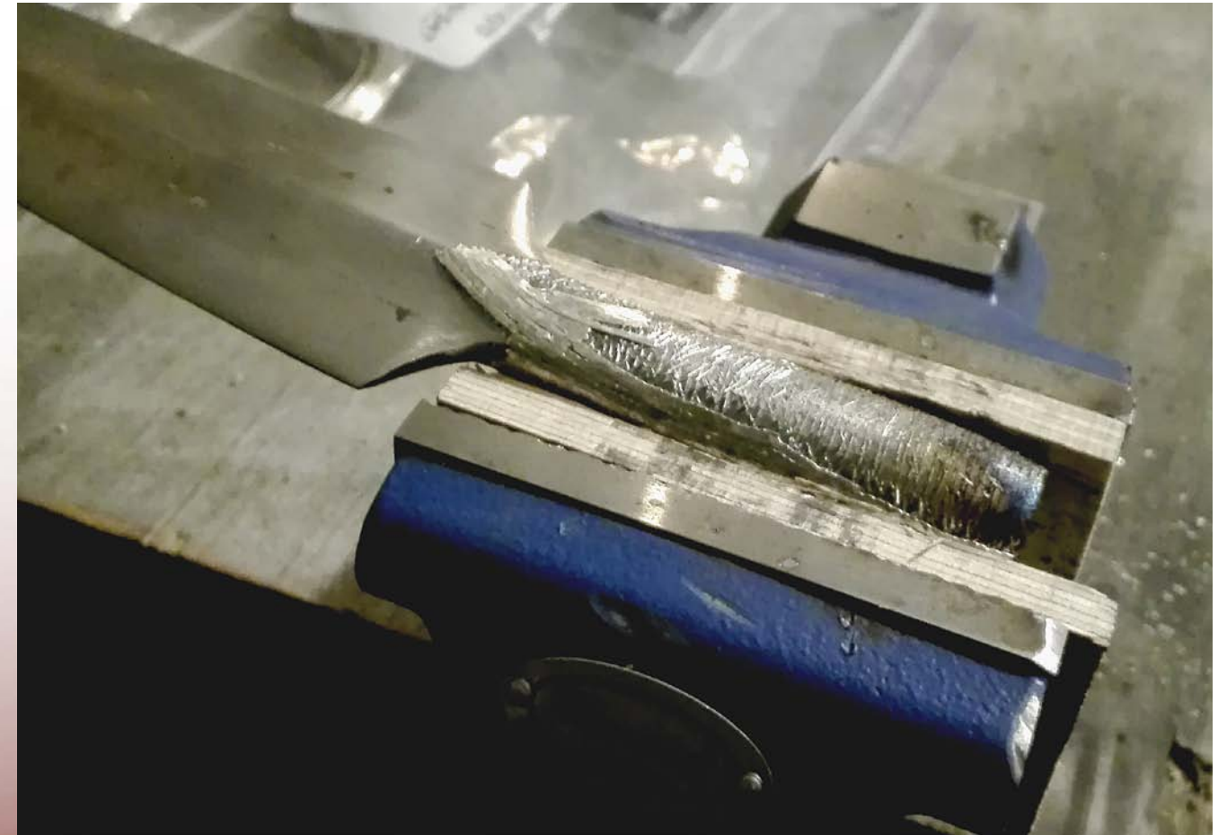
↑ Keihäänkärjen putki voitiin hopeoida vasaromalla sen karhennettuun pintaan hopealankoja vieri vieren. Kun langat vasaroidaan tasaiseksi, muistuttaa lopputulos yhtenäistä hopeapintaa. KUVA MIKKO MOILANEN
